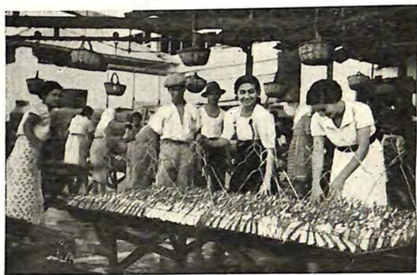
Die mit Sardinen gefüllten Drahtbehälter, rein stannierte, sind kurze Zeit zum Trocknen aufgestellt, bevor sie, mittels Dampf, gekocht werden
