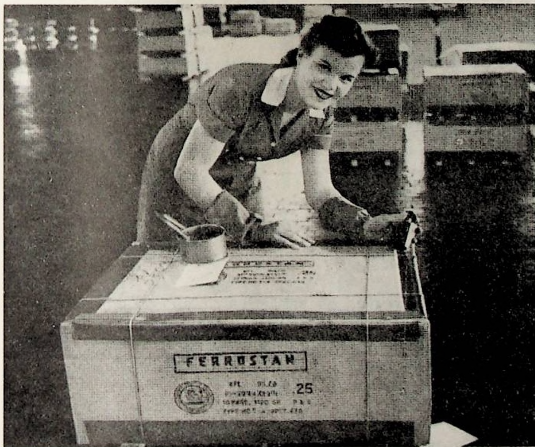
Folha Electrolytica (Ferrostan), com um novo tipo de embalagem composto de papel e fibra canelada, também adoptado pela United States Steel, Export Company, de New York. Evita a ferrugem e oferece um máximo de protecção material.
