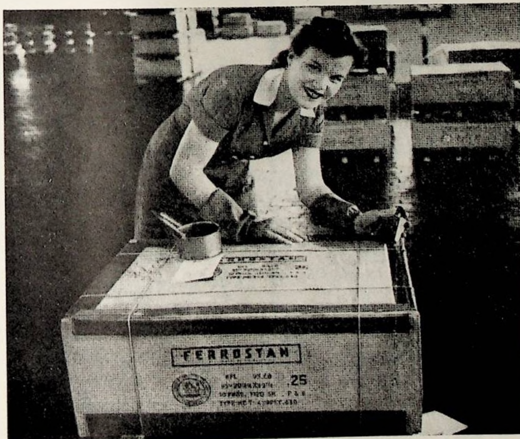
Folha Electrolítica (Ferrostan), com um novo tipo de embalagem composto de papel e fibra canelada, também adoptado pela United States Steel, Export Company, de New York. Evita a ferrugem e oferece um máximo de protecção material.
