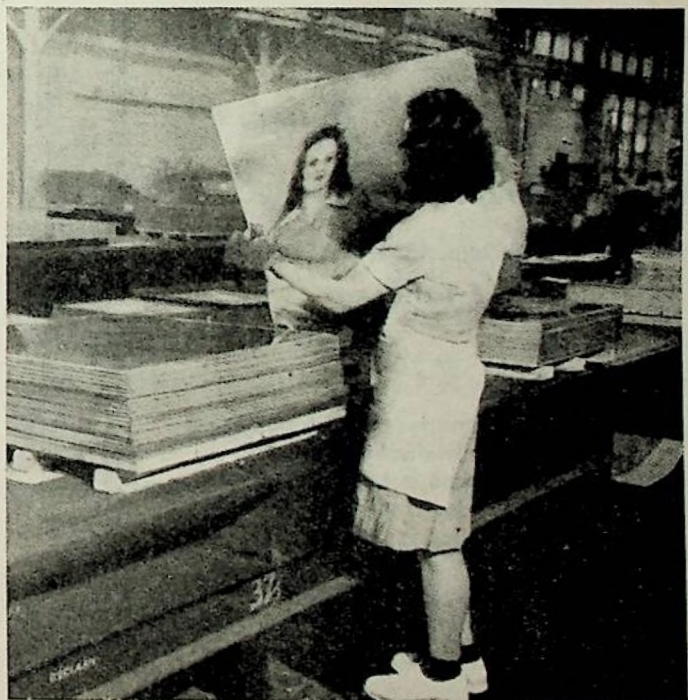
Inspeção e classificação da Folha de Flandres
