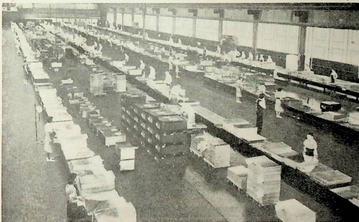
Vista geral da secção de inspecção da Folha de Flandres. Nesta secção faz-se a inspecção do acabamento da superfície da Folha de Flandres Coke
