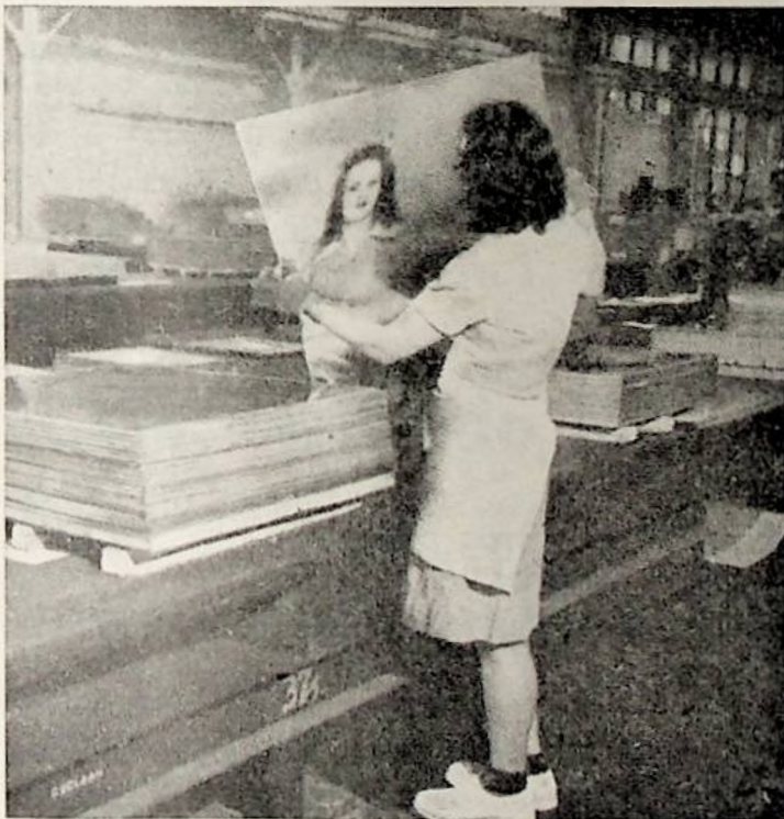
Inspeção e classificação da Folha de Flandres
