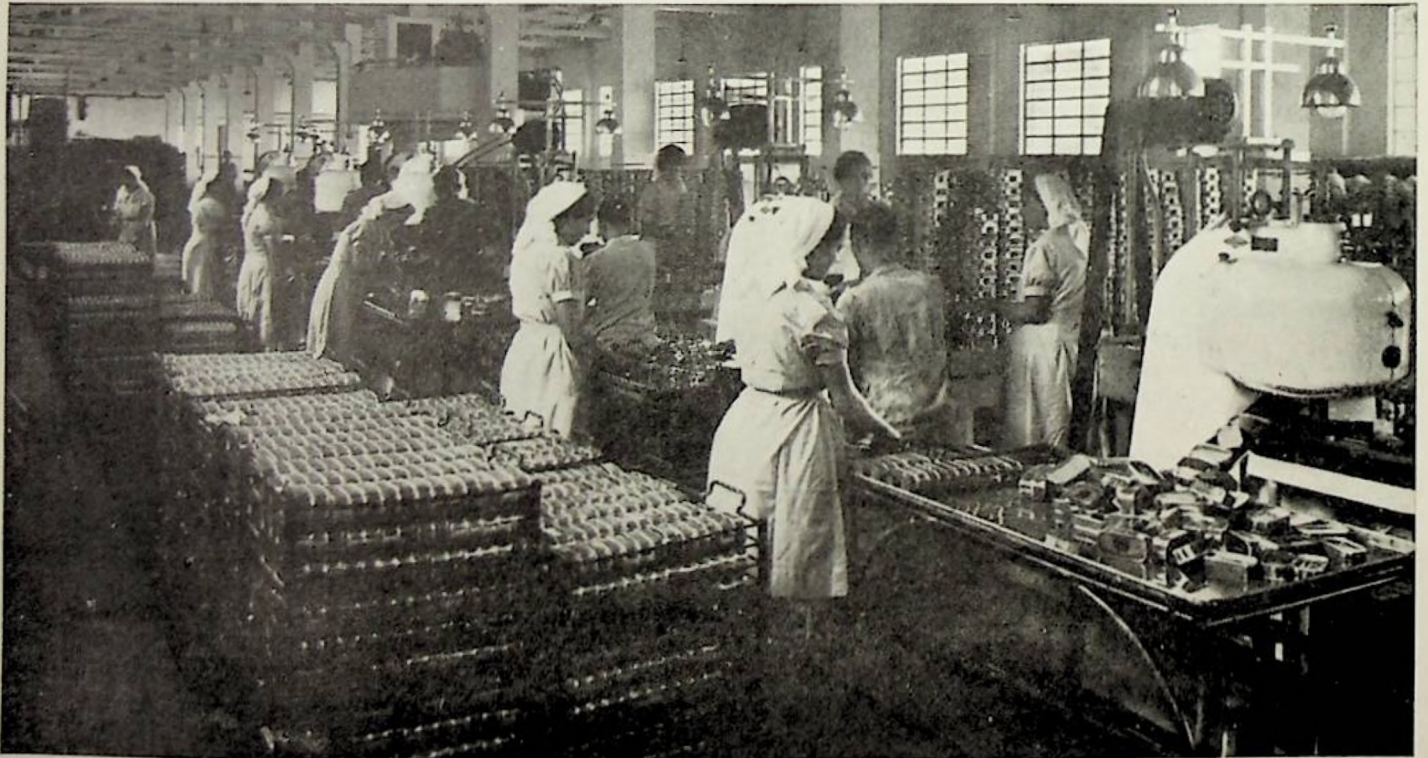
As latas, depois de fechadas pelas cravadeiras, são dispostas em cestos nos quais são levadas para os autoclaves para serem esterilizadas
