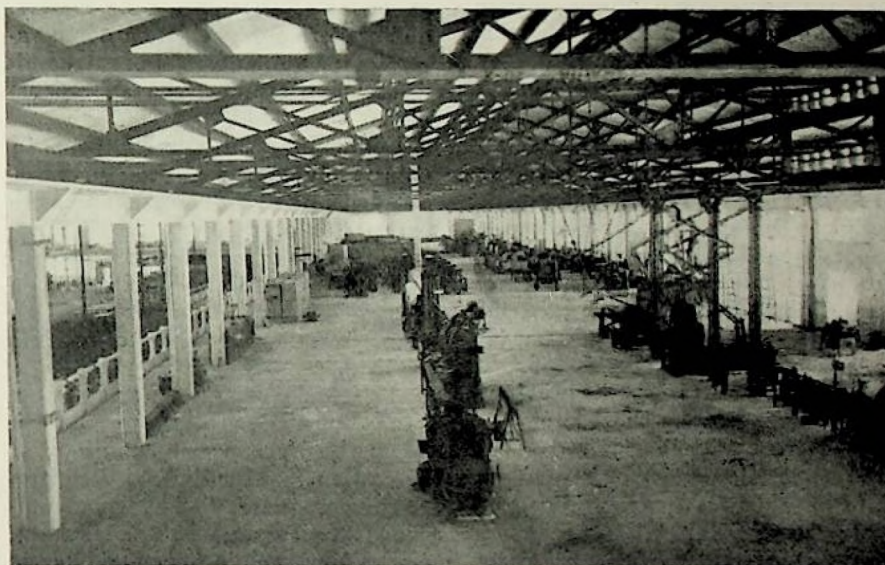
Fábrica de Cangas — Linhas automáticas para a fabricação de latas vasias
